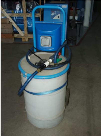
Sistema relleno automático agua baterías.
